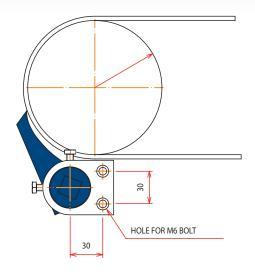
ø 80 - ø 200 Für Geschwindigkeiten bis ca. 1,6 m/Sekunde geeignet
